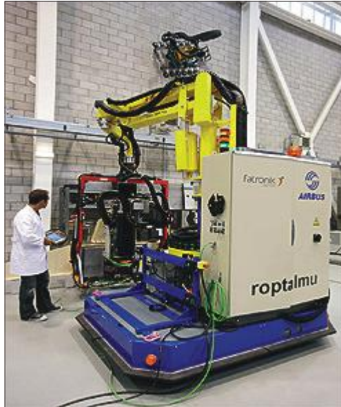
Le Roptalmu utilisé pour le perçage pour l'installation des grandes pièces composites le long de la queue de l'Airbus A380 et A340.
