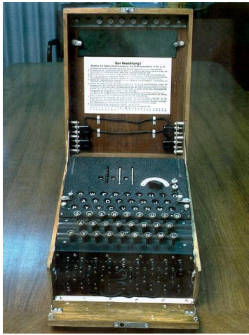
صورة رقم ٢ آلة أنيغما - تعمل كهروميكانيكي دارة - مهمتها تشفير المعلومات والاتصالات. مصدر الصورة ويكيبيديا.
